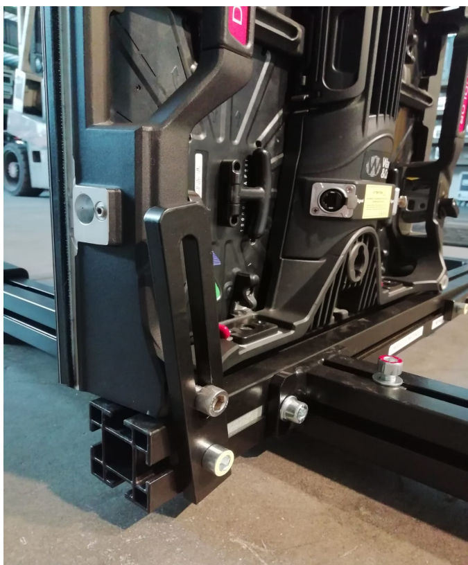
fissare i moduli Led come indicato
