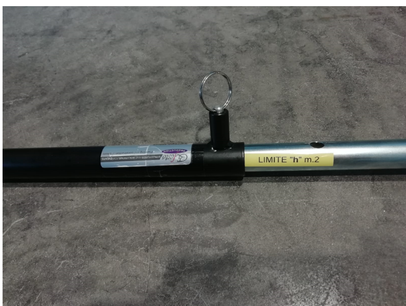
Estensione max aggancio sul Led ad altezza di 2 mt.
