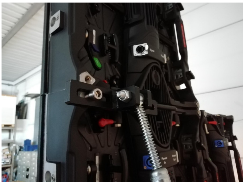
Montaggio staffa di supporto
